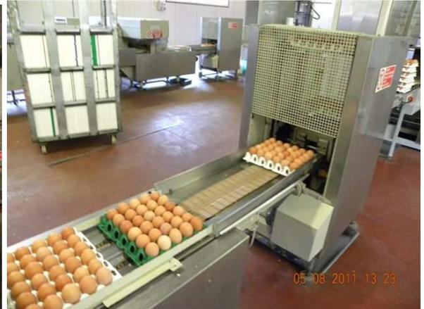
L'operatore aziona a distanza il movimento dei nastri e le uova vengono posizionate su un nastro trasportatore a catena tipo "anaconda" che le trasferisce presso il centro di raccolta (CR) dove una macchina le confeziona su platò pronte per essere inviate mediante navetta, al centro di selezione e confezionamento (sito a S. Giovanni di Ciliano - PG). Il corretto funzionamento della macchina è tenuto sotto controllo dal personale addetto.
