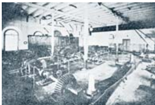
Le officine Oerlikon e Ganz, installate presso l'officina meccanica, alimentate dalle acque del canale Nerino (3,5 mc/s) e da quelle del Raggio Vecchio (3,6 mc/s) (G. Merlotti e L. Panzani, Guida illustrata di Terni e dintorni, Terni 1899).
