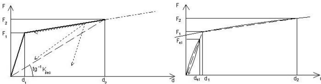
Figura 10.1 – Diagrammi forza – spostamento per dispositivi non lineari
