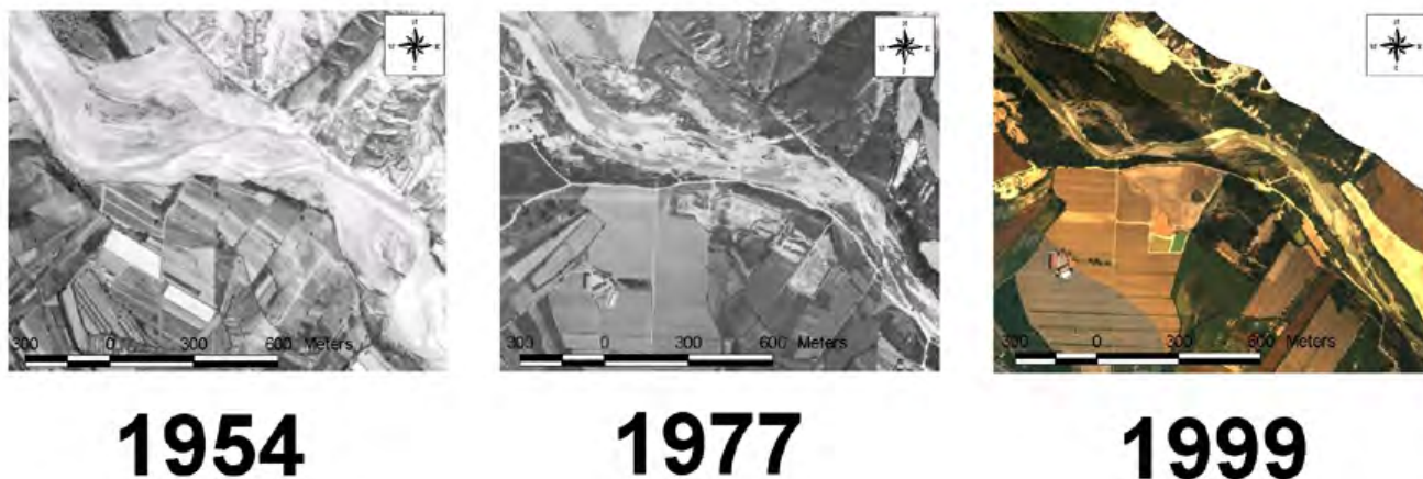
Fig. 29 - Variazione dello stato del sistema fluviale del F. Paglia, evidenziato dal confronto tra riprese aeree effettuate in periodi diversi.
