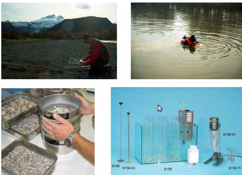
Fig. 8 - I metodi di campionamento e di analisi dei sedimenti dell'alveo variano a seconda delle dimensioni degli stessi e della tipologia di alveo: la distribuzione granulometrica può essere determinata per setacciatura per i sedimenti più grossolani, mentre quella dei sedimenti più fini viene determinata per decantazione. Allo stesso modo, quando l'alveo è esposto, è più facile campionare i sedimenti, mentre quando il fondo rimane permanentemente sommerso può rivelarsi necessaria l'opera di un sommozzatore.
