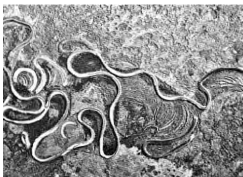
Fig. 2 - Un alveo a meandri. L'alveo è mobile dal punto di vista planimetrico, in quanto il canale cambia la sua posizione assoluta nel tempo, ma la forma del tracciato, con le sue anse e l'accentuata sinuosità, rimane inalterata. Dal punto di vista geomorfologico, questa forma è stabile.
