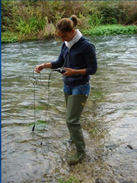
Ph-metro per il calcolo dell'acidità
